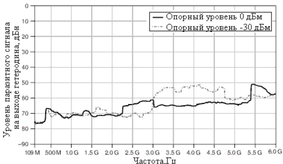
Рисунок 5. Уровень остаточного сигнала на выходе гетеродина, дБн 8 .
