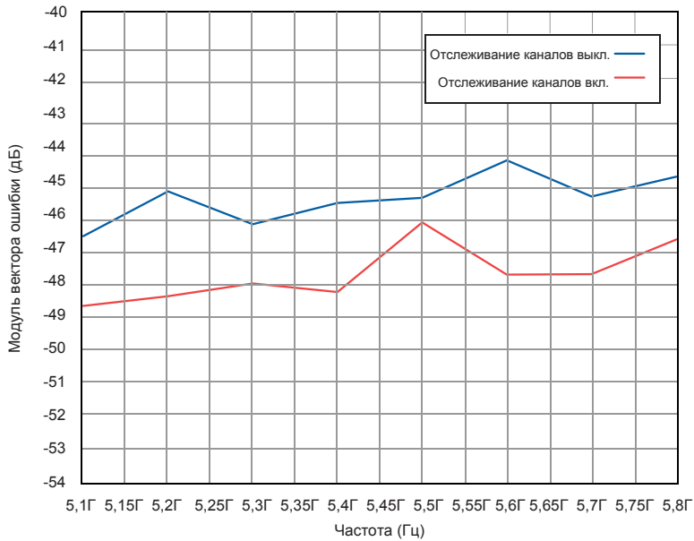
Рис. 20. WLAN 802.11ac: измеренный ср. квадр. модуль вектора ошибки (дБ) в зависимости от частоты (Гц), полоса 80 МГц 19
